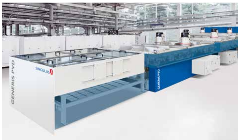
GENERIS PVD Kathodenzerstäubungsanlage für die Beschichtung von Heterojunction Hochleistungs-Solarzellen
